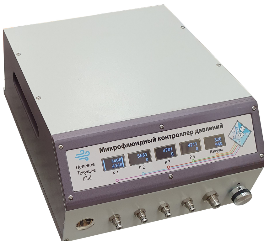
Рис. 1 – Внешний вид микрофлюидного контроллера давлений с пятью дисплеями, четырьмя выходами для положительного давления и одним выходом для вакуумного насоса
